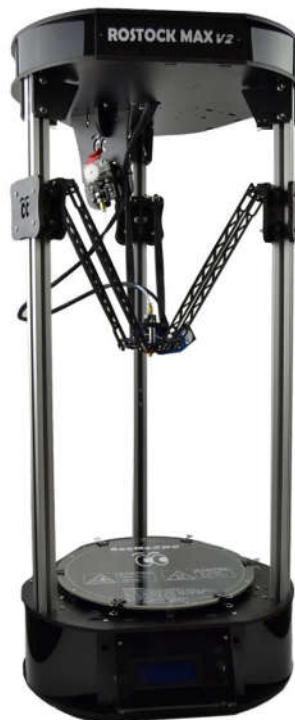
Figura 8 – Impressora 3D Delta
